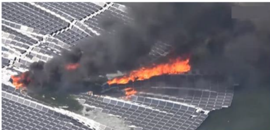
Figure 1 – Exemple d'un incendie sur des îlots solaires (d'après le diaporama de De Billy (V.), 2024) :
